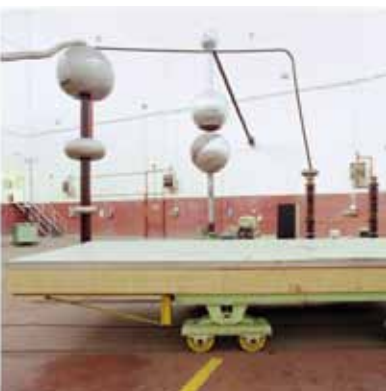
3. Divisore capacitivo per prove a frequenza industriale (a sinistra) Caratteristiche tecniche Tensioni nominali: 750.000 /1500 V Capacità di stadi: 400 pF Numero di stadi: 3 Frequenza: 50 Hz Spinterometro a sfere (al centro) da 1,5 m di diametro e tensione nominale 1,6 MV
