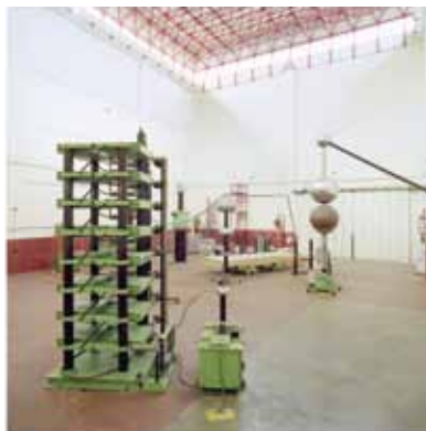
1. Generatore impulsi Caratteristiche tecniche Valore di picco massimo: 1,6 MV Forma d'onda impulsiva: 1,2/50 µs Numero di stadi: 8 Tensione nominale unità di raddrizzamento: 200 kV Altri valori di picco massimi ottenibili mediante riconfigurazione del circuito: 800 kV, 400 kV e 200 kV.
