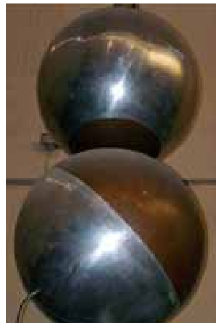
Divisore capacitivo per prove a frequenza industriale; spinterometro a sfere da 1.5 m di diametro e tensione nominale 1.6 MV
