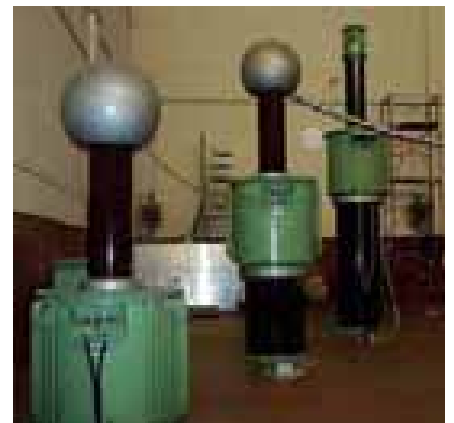
Trasformatori monofasi per alte tensioni collegati in cascata Caratteristiche tecniche: Tensione nominale primaria: 500 V Tensione nominale secondaria: 250.000 V Potenza nominale: 225 kVA (I unitá) ; 150 kVA (II unitá); 75 kVA (III unitá) Frequenza: 50 Hz Tensione di corto circuito: 4.7%
